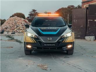
Über außen angebrachte wasserdichte Steckdosen lassen sich elektrische Geräte direkt mit der leistungsstarken Lithium-Ionen-Batterie des Fahrzeugs verbinden. Auf diese Weise können beispielsweise medizinische Geräte, Kommunikationsmittel, Beleuchtung und andere Ausrüstung auch nach einem Ausfall der öffentlichen Stromversorgung betrieben werden.
