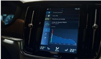
Dank eines Filters auf Kunstfaserbasis und Ionisierung werden bis zu 95 Prozent der mikroskopisch kleinen Feinstaubpartikel der Partikelgröße PM2,5 aus der Luft herausgefiltert, bevor sie in die Fahrgastzelle gelangen. Deren aerodynamischer Durchmesser ist kleiner als 2,5 Mikrometer und deshalb besonders gefährlich.
